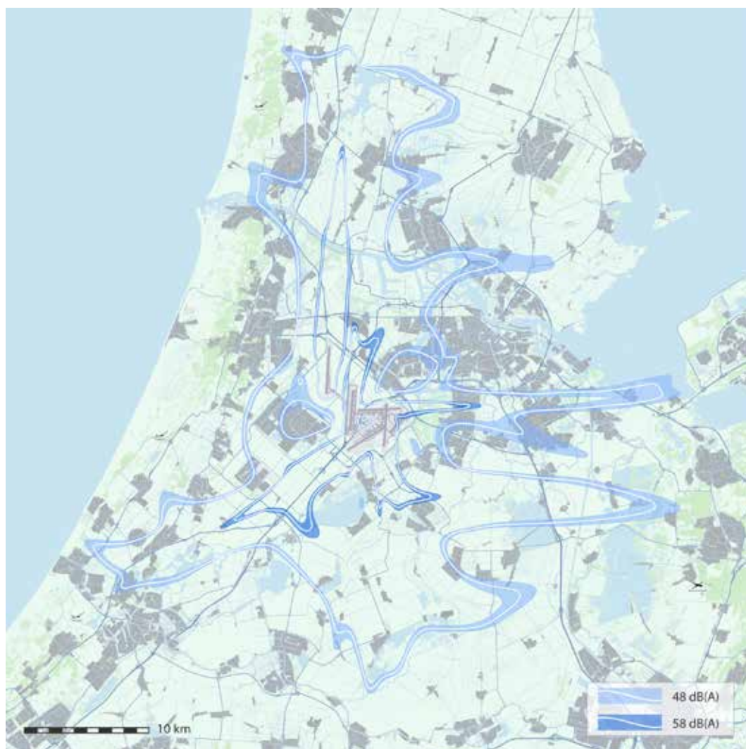
Figuur 5.1 Verwachte jaargemiddelde geluidbelasting over het etmaal L_{den}
