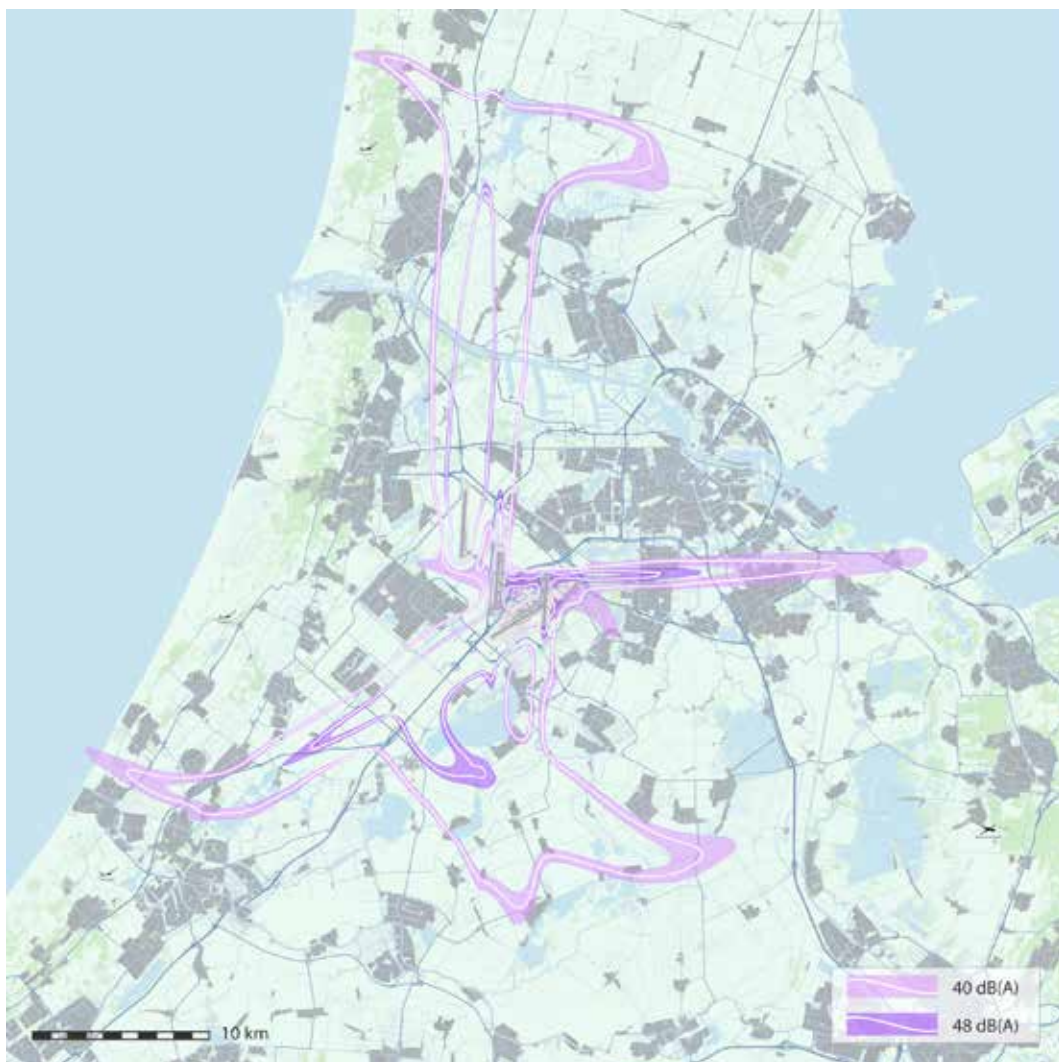
Figuur 5.2 Verwachte jaargemiddelde geluidbelasting over de nachtperiode L_{night} voor het gebruiksjaar 2017, met spreiding als gevolg van weersvariaties
