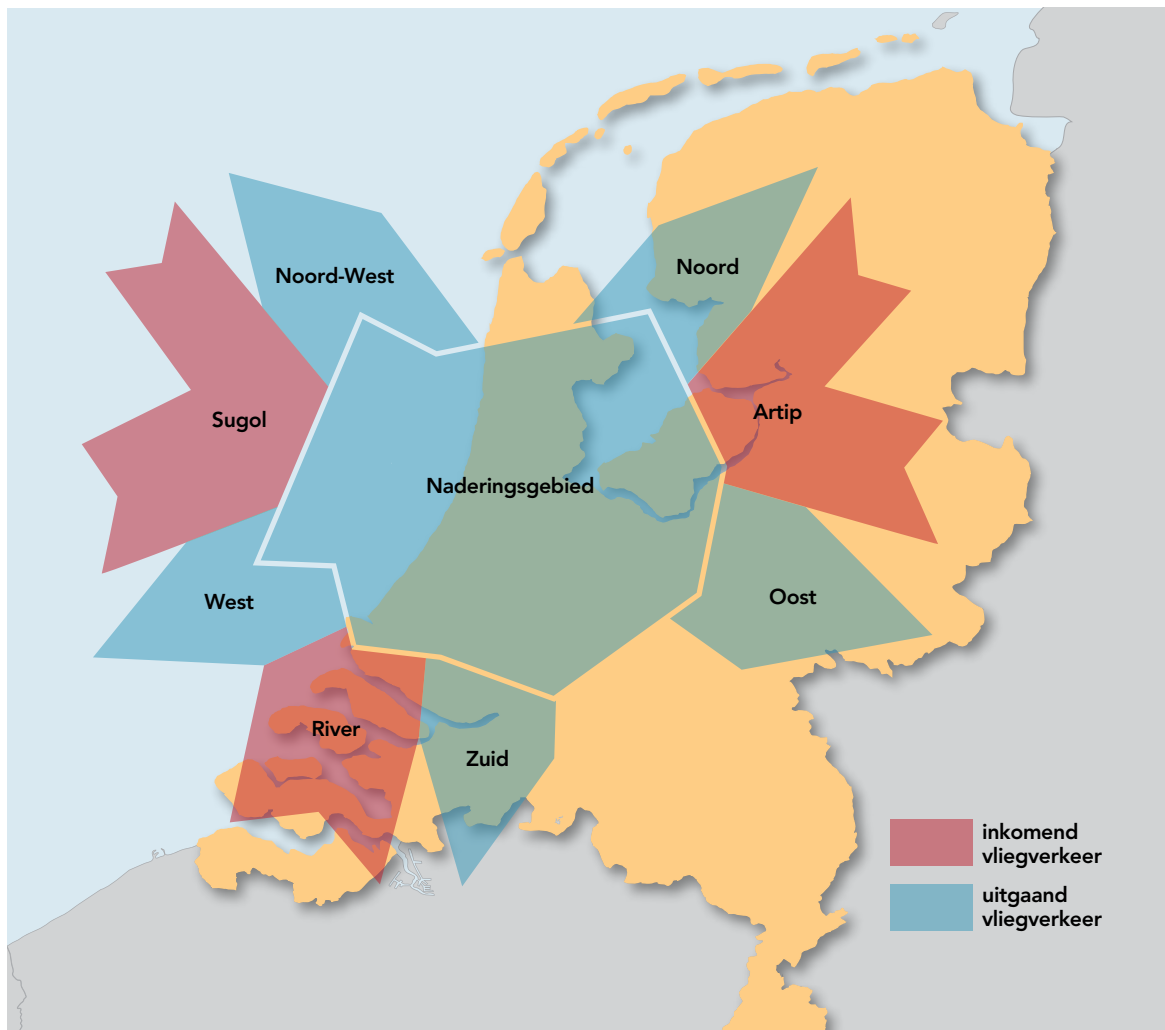
Figuur 5: Schets van de vijf corridors voor inkomend en uitgaand vliegverkeer en het naderingsgebied van Schiphol.
